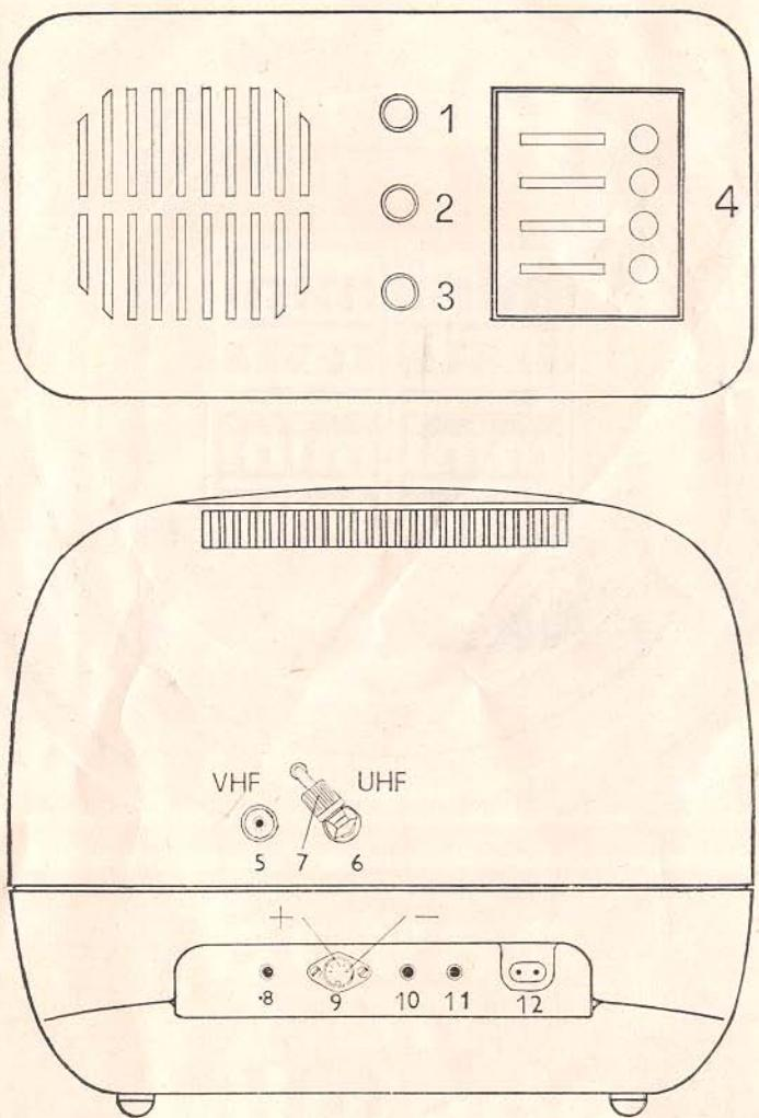
MINITESLA je prenosný, úplne tranzistorovaný televízny prijímač s uhlopriečkou obrazovky 31 cm, pre prijem televíznych programov v pásmach VHF a UHF. Televízny prijímač je možné napájať aj jednosmerným napäťom z akumulátorovej batérie 12 V.
