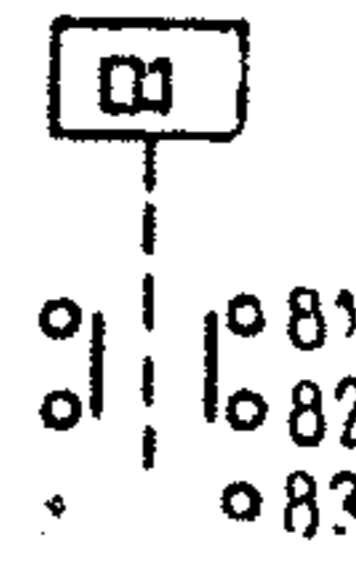
vypínač vnitřního reproduktoru kreslen v poloze „reproduktor vypnut“
