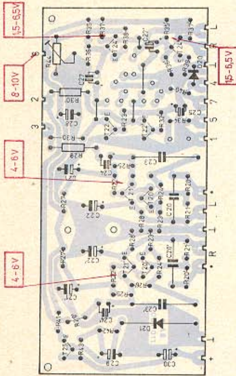
Obr. 10. Deska předzesilovače (strana spojů)
