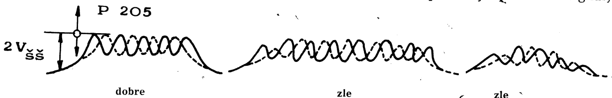
Obr. 12. Priebeh nastavenia identifikácie SECAM
